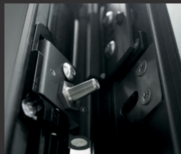
Perni antifurto sono accessori aggiuntivi che aumentano la resistenza antieffrazione delle porte. Montati dal lato delle cerniere sull'anta e sul telaio. A seconda del grado di protezione richiesto, è possibile applicare diverse quantità di set per anta.
